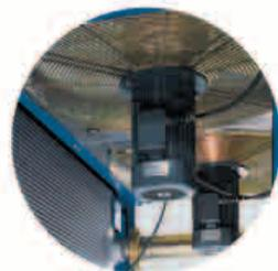
冷却风扇使冷却空气穿过机组带走所有辐射热量
